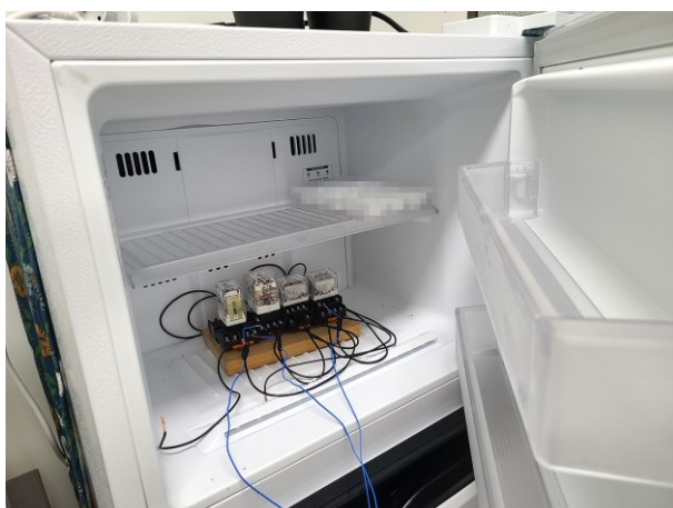
<2 hours of LLT condition at -15 °C>
