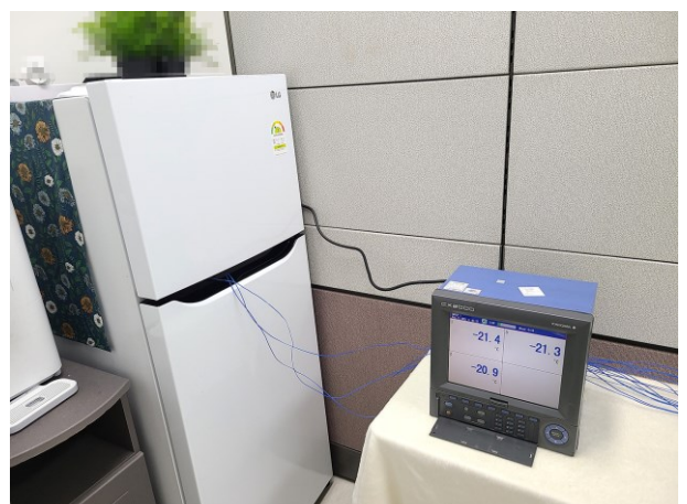
<2 hours of LLT condition at -15 °C>
